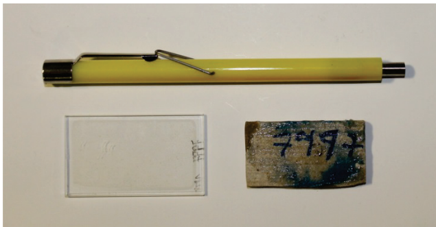
Abb. 2: Dünnschliff der zu untersuchenden Gesteinsprobe. (Magnetstift = 12,5 cm)
